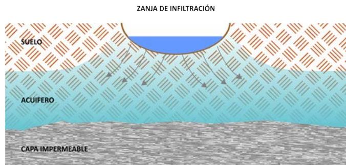
Figura 22. Esquema de Recarga de Acuífero
