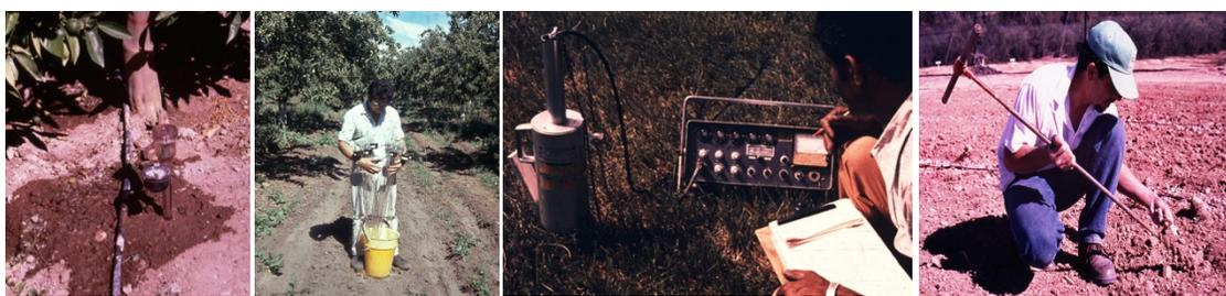
Figura 28. Instrumentos para la medición de la humedad del suelo
