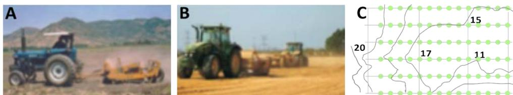
Figura 48. [A] Traílla; [B] Niveladora; [C] Plano Topográfico
